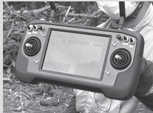
専用のプロポと呼ばれるコントローラーが2台付属し、スタート地点と着地点でそれぞれ操作を行う仕組み。
