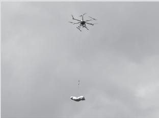
1回のフライトで最大25kgの荷物を運搬可能。1日60フライトとすると約1.5tの運搬ができるようになり、人力での100往復分に相当する。
